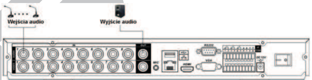
Rys. 3-3a. Podłączenia wejść i wyjść audio do rejestratora 8-kanalowego z serii LE-A.
