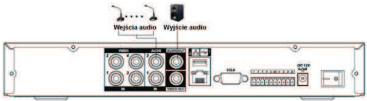
Rys. 3-3b. Podłączenia wejść i wyjść audio do rejestratora 4-kanalowego z serii LE-AS (LE-AN).
