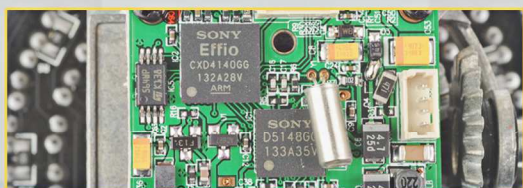
Procesor SONY Effio-E, przetwornik EXview HAD CCD II 1/3" firmy SONY
