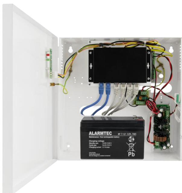
Przykładowy montaż S64-B z akumulatorem (akumulator nie wchodzi w skład zestawu)
