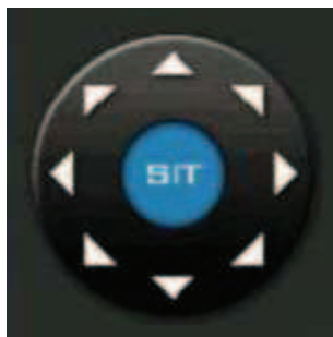
Rys. 4-22. Przycisk wielokierunkowy sterowania głowicą PTZ.
