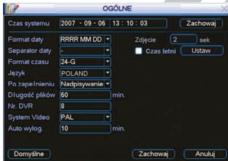
Rys. 4-9c. Ustawianie parametru czas zdjęcia w menu Ogólne.
