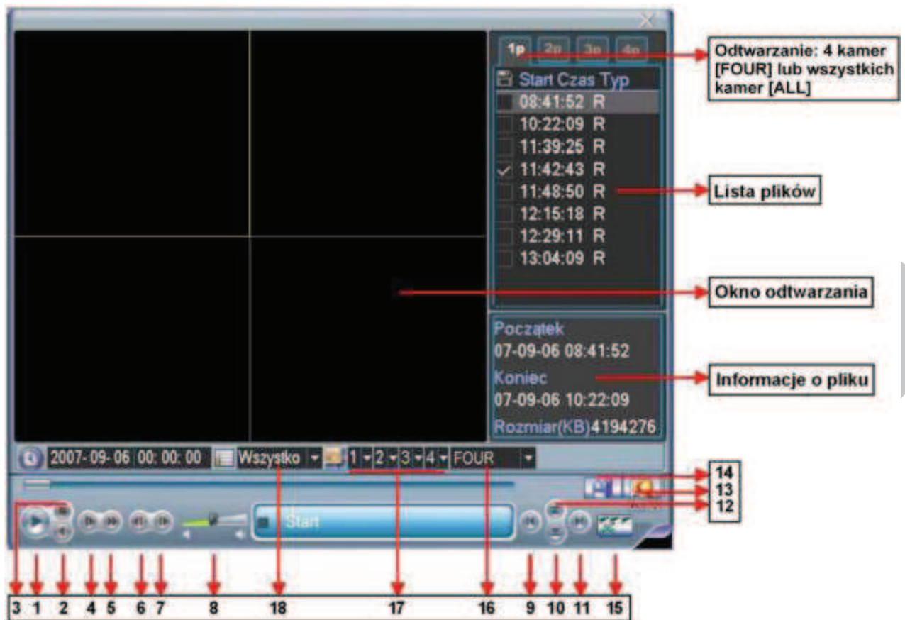
Rys.4-7. Ekran menu Wyszukiwanie – rozmieszczenie elementów. Uwaga: Jest to rysunek poglądowy o nienaturalnych proporcjach
