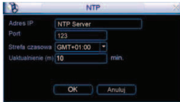
Rys. 5-10. Ustawianie parametrów NTP.
