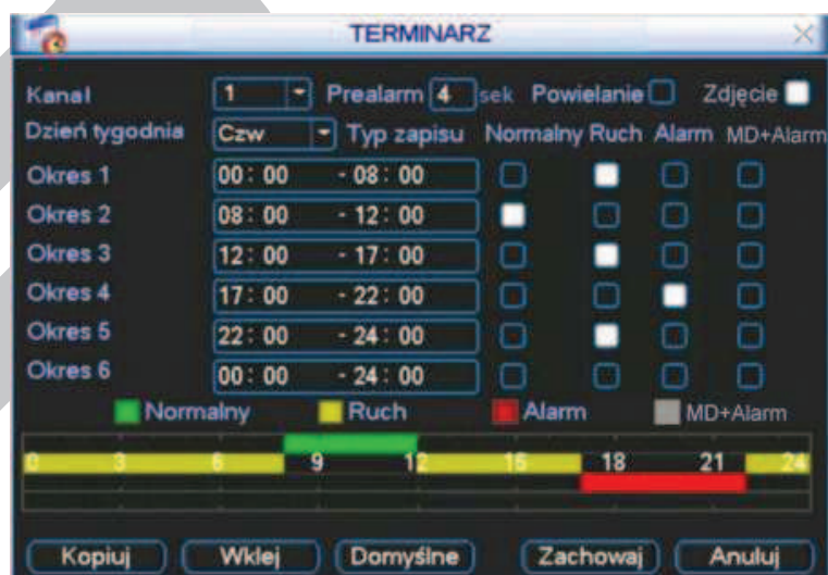
Rys. 4-9d. Ustawianie aktywacji wykonywania zdjęć w menu Terminarz.
