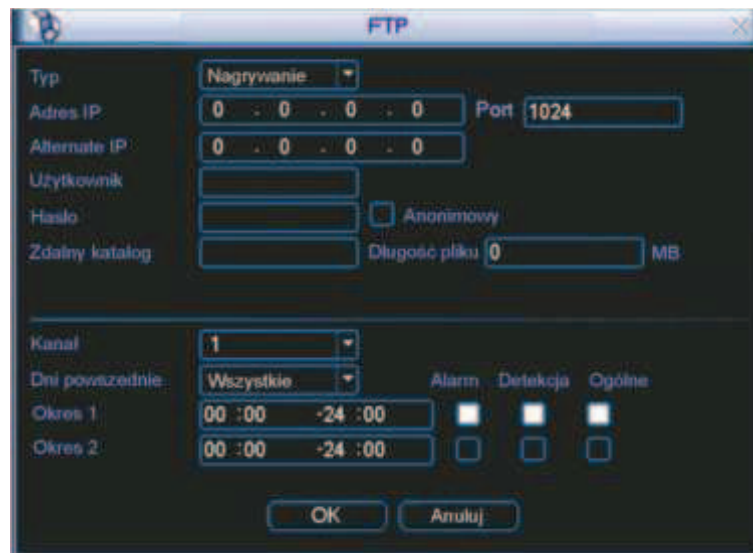
Rys. 4-9f. Ustawianie parametrów serwera FTP.
