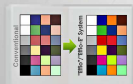
Doskonałe odwzorowanie kolorów poprzez układ Effio, bardzo szeroki zakres ATW (1800K do 10500K)
