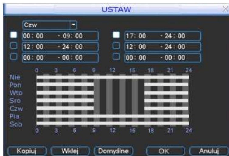
Rys. 4-24. Ustawiane okresów nieaktywności reakcji na pobudzenie wejścia alarmowego.
