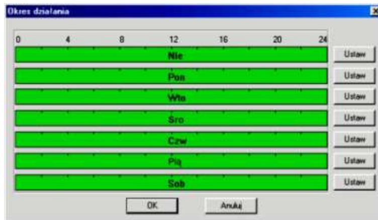
Rys. 7-41a. Ustawianie okresu aktywności wejścia alarmowego.
