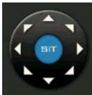
Rys. 4-32. Przycisk wielokierunkowy sterowania głowicą PTZ.
