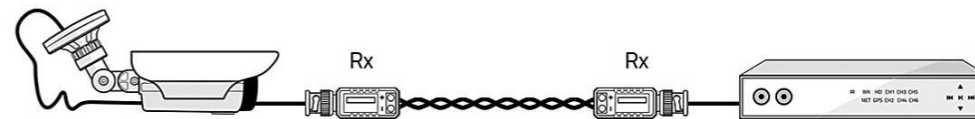
kamera AHD skrętka komputerowa - kabel UTP kat. 5e/6 rejestrator AHD przesył do 300m przy 720p przesył do 200m przy 1080p
