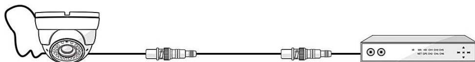
kamera AHD kabel koncentryczny 75 Ohm - przesył do 500m rejestrator AHD
