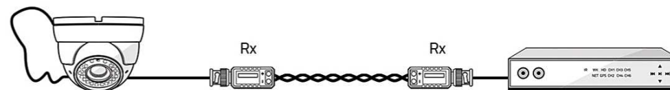
kamera AHD skrzętka komputerowa - kabel UTP kat. 5e/6 rejestrator AHD przesył do 300m przy 720p przesył do 200m przy 1080p Rx - pasywny odbiornik AHD
