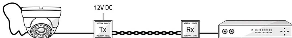
kamera AHD skrzętka komputerowa - kabel UTP kat. 5e/6 rejestrator AHD przesył do 500m przy 720p przesył do 300m przy 1080p
