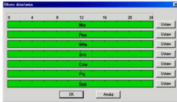
Rys. 7-41a. Ustawianie okresu aktywności wejścia alarmowego.
