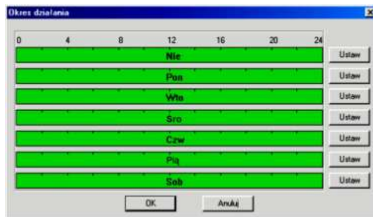
Rys. 7-38a. Ustawianie okresu aktywności wejścia alarmowego.
