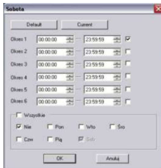
Rys. 7-41b. Ustawianie terminarza aktywności wejścia alarmowego.
