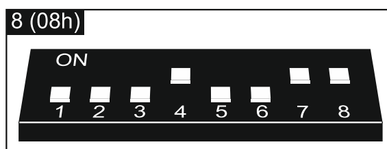
Rys. 10. Sposób ustawienia przełączników DIP-switch w kontrolerze ACU-100.
