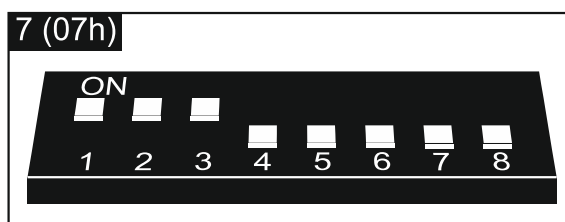
Rys. 5. Sposób ustawienia adresu w ekspanderze INT-RX-S / INT-RX.
