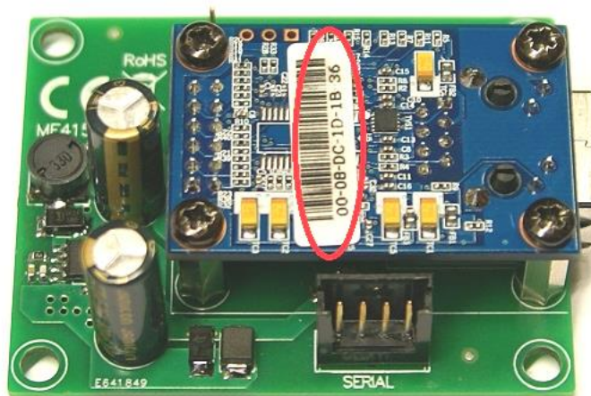
Rys. 5. Umieszczenie adresu MAC na module interfejsu INTE.
