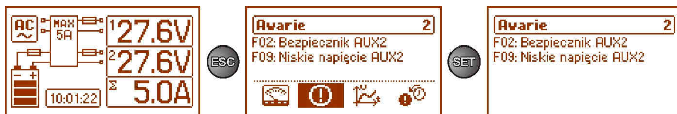
Rys. 12. Ekran – bieżące awarie zasilacza.
