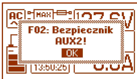
Rys. 11. Komunikat sygnalizujący przepalenie bezpiecznika na wyjściu AUX2.
