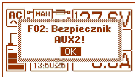
Rys. 11. Komunikat sygnalizujący przepalenie bezpiecznika na wyjściu AUX2.
