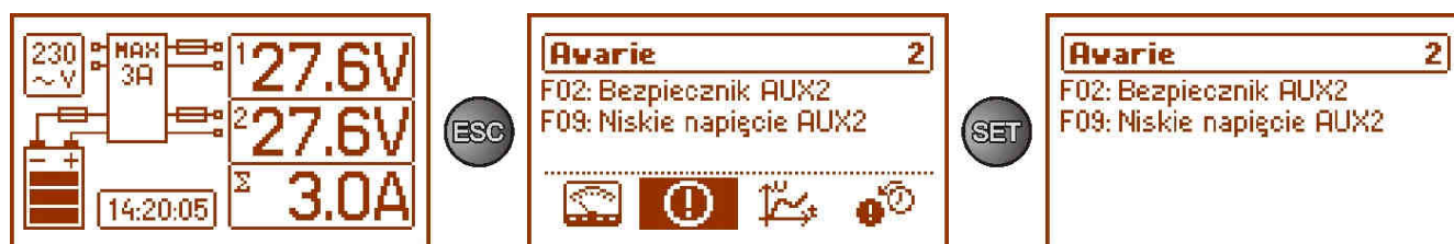
Rys. 12. Ekran – bieżące awarie zasilacza.
