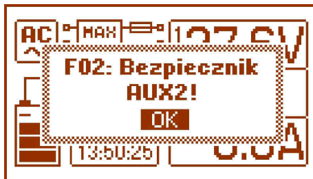
Rys. 11. Komunikat sygnalizujący przepalenie bezpiecznika na wyjściu AUX2.
