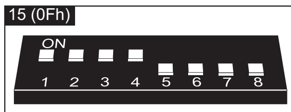
Rys. 20. Sposób ustawienia adresu w ekspanderze wyjść.
