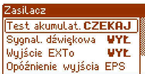
Rys. 27. Czasowe zablokowanie testu akumulatorów.
