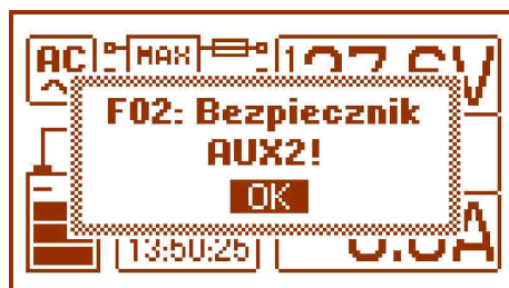
Rys. 11. Komunikat sygnalizujący przepalenie bezpiecznika na wyjściu AUX2.
