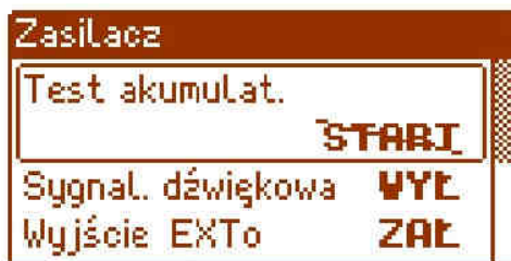
Rys. 28. Test akumulatorów – nieaktywny.
