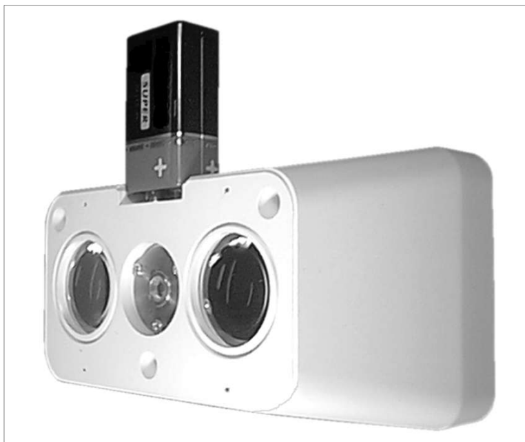
Rys. 2 Czujka DOP-40R podczas zestrainiania toru optycznego
