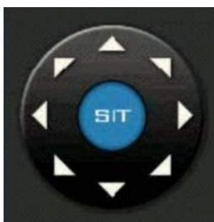
Rys. 4-22. Przycisk wielokierunkowy sterowania głowicą PTZ.
