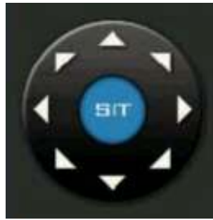
Rys. 2-22. Przycisk wielokierunkowy sterowania głowicą PTZ
