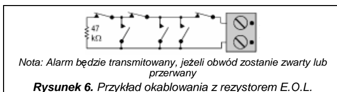
Rysunek 6. Przykład okablowania z rezystorem E.O.L.
