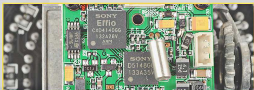
Procesor SONY Effio-E, przetwornik EXview HAD CCD II 1/3" firmy SONY
