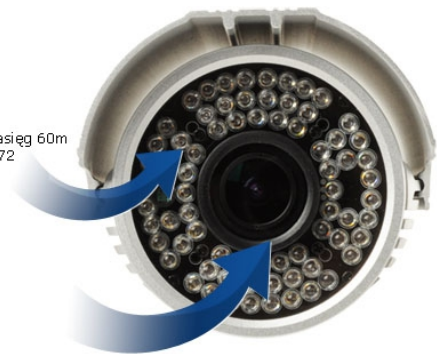
Podwójna szybka eliminuje efekt przenikania światła IR do obiektywu
